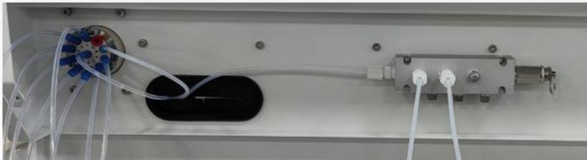
转动阀和标配的内置增压实现二氯甲烷等低沸点溶剂实现精确吸取
